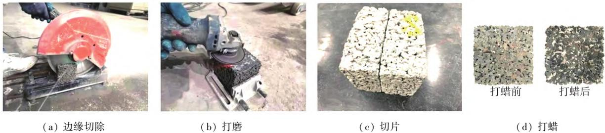
图 1 试件加工制作过程
