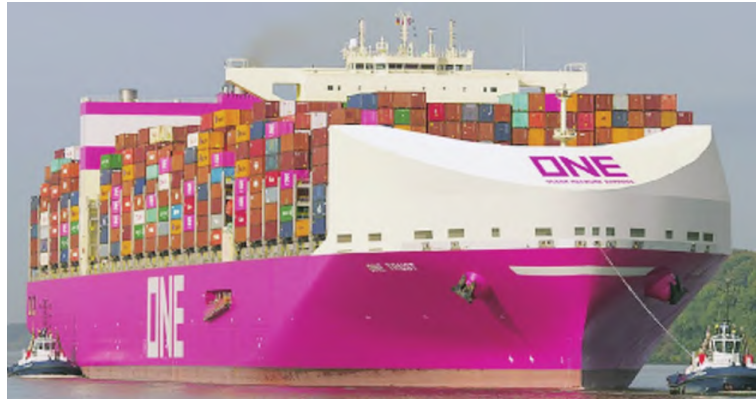
图 1 日本 ONE 船舶联盟超大型集装箱船挡风墙安装效果 [14]
