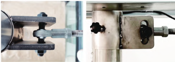
图 6 模型与加载装置的连接细部图
