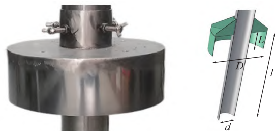
图 3 模型桶结构与模型符号说明
