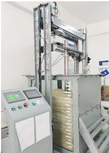
图 2 JZG-YZY-50 型海洋桩基模型试验系统
